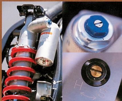
アルミスイングアーム。イニシャルは無段階、減衰力は圧側高速側 3 $\frac{1}{2}$ 回転、低速側20段のダブルアジャスター、伸側21段に調整でき、路面コンディションや技術レベルに合わせた微妙なセッティング変更を可能にする。圧側ダブルアジャスターはモトクロスサーRMシリーズと同タイプ。オフロードでのハードな路面状況に対応する高速側とツーリング
