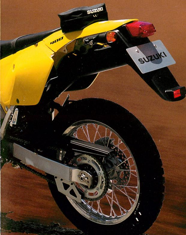
繊細なとしなやかさをもつサスペンション。フロントフォークには、正立式カートリッジタイプを採用。インナーチューブはφ49mmの極太径。高剛性かつしなやかな乗車感を生む。減衰力は圧側14段・伸側18段に調整でき、路面追従性と走破性を追求。リヤサスペンションは、シリンダー径φ46mmのピギーバック式十大型角断面
